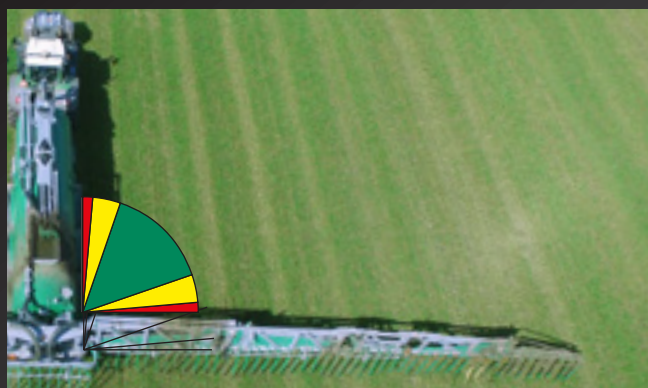
Vinkelsensorerne styrer indervingens hastighed under foldning. Grøn: Max. hastighed, Gul: Reduceret hastighed og Rød: Bommen stoppes.
