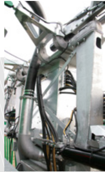
Bommen har en simpel midterramme uden bevægelige dele.
