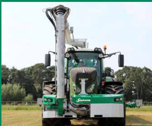
Le bras de remplissage installé sur le côté assure un champ de vision optimal de la cabine.
