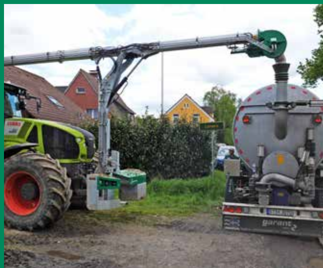
Le système de remplissage FAP est particulièrement compact, avec une profondeur totale de 774 mm en haut et de 502 mm en bas. C'est le plus petit du marché.
