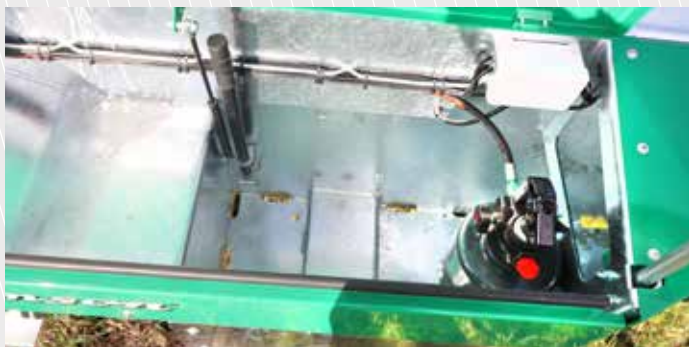
La pompe à main est bien protégée dans le coffre.
